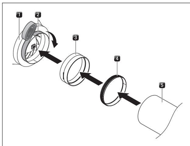
Fig. 4.1 Raccordement avec le système de canaux BORA Ecotube
