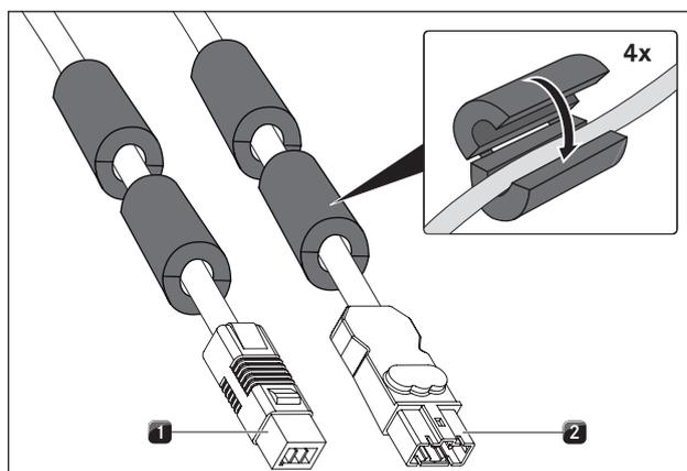
Fig. 5.2 Fiche de connexion du ventilateur pour toit en tuiles
