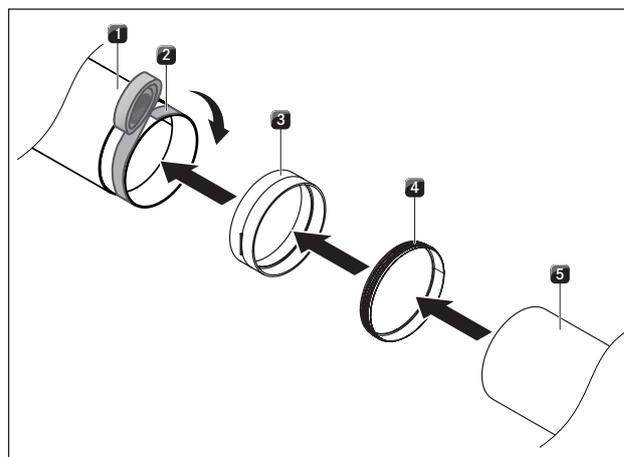
Fig. 5.1 Raccordement avec le système de canaux BORA Ecotube
