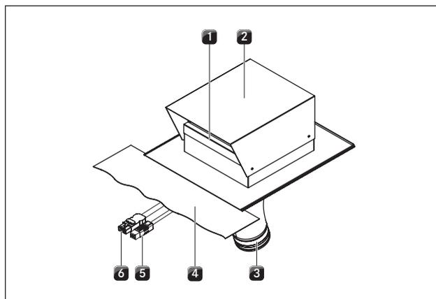
Fig. 5.1 Composition du ventilateur pour toit en tuiles
