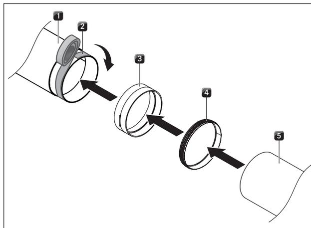
Abb. 5.1 Verbindung mit Kanalsystem BORA Ecotube
