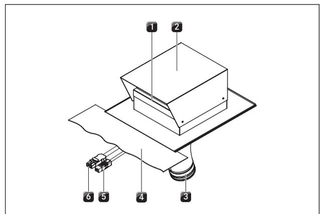
Abb. 3.1 Aufbau Ziegeldachlüfter
