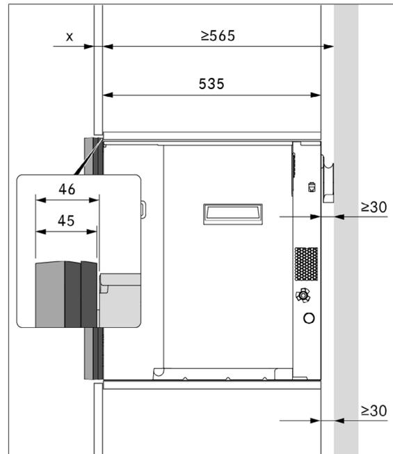
Fig. 9.5 Dimensioni di montaggio 2 distanziatori cornice
