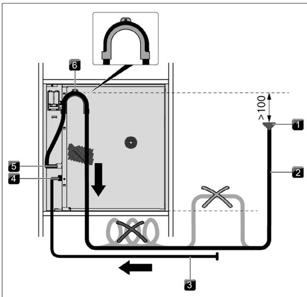
Fig. 9.12 Scarico dell'acqua sopra raccordo
