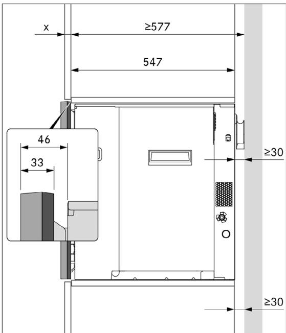
Fig. 9.4 Dimensioni di montaggio 1 distanziatori cornice
