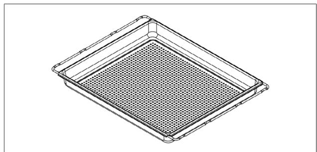
Fig. 4.5 Cestello di cottura in acciaio inox, forato
