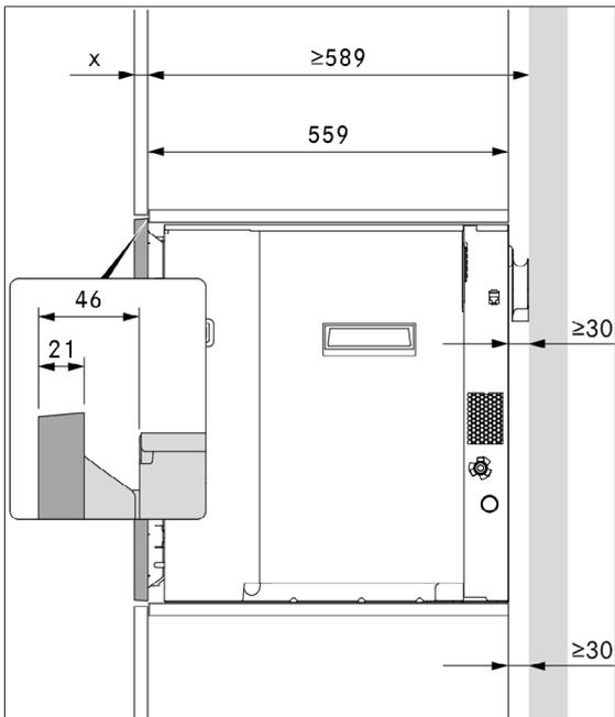
Fig. 9.3 Dimensioni di montaggio senza distanziatore cornice
