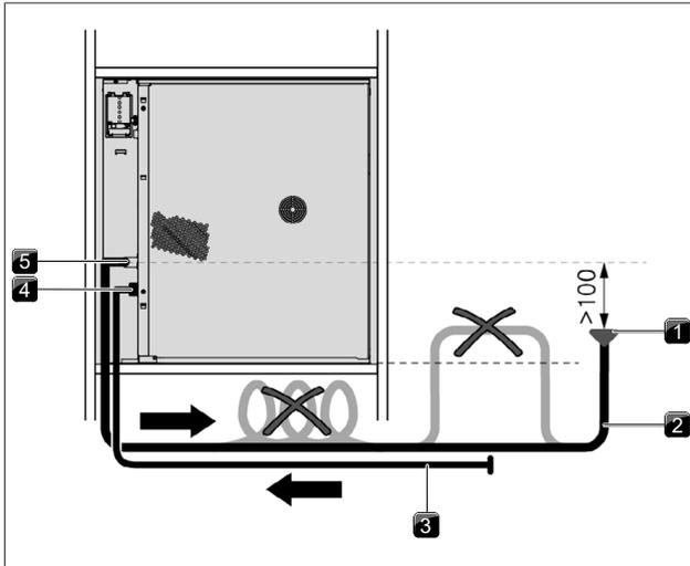
Fig. 9.11 Scarico dell'acqua
