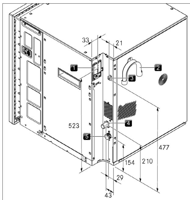
Fig. 9.10 Collegamento all'apparecchio
